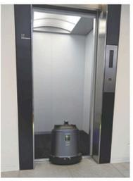
写真6 エレベーター連携によって、人の手を介さずロボットがフロア移動を実現
